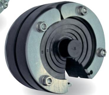
Die **Pressio® Universal Ringraumdichtung** ist als **Einzel-durchführung** oder als Blindverschluss einsetzbar. Aufgrund ihres weichen Gummis sind die Pressio® Universal Ringraumdichtungen auch besonders für Kunststoffrohre geeignet. Der Dichtbereich für die Durchführung eines Rohres/ Kabels ist mit Gummilamellen abgestuft und somit für verschiedene Außendurchmesser einsetzbar.
