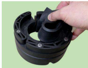
4. Zum Abtrennen der Lamellen werden diese nach hinten durchgedrückt und anschließend mit einem Messer abgetrennt oder von Hand abgezogen.
