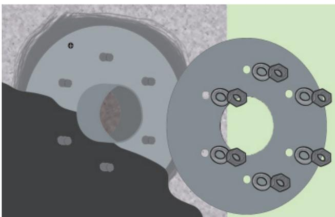
4. a) Dichtungsbahn anlegen, Losflansch als Schablone verwenden und Löcher für Durchführung/Schrauben mittels Locheisen ausschneiden.
