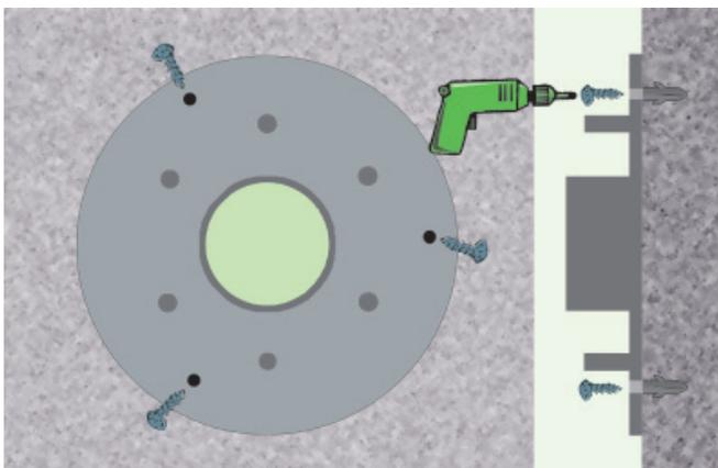
2. Vorbaumauerhülse Festflansch mit den mitgelieferten Senkschrauben montieren.
