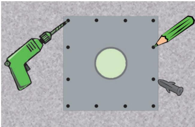
Die Vorbaumauerhülse 4 pipes ist auf einer ebenen, glatten und tragfähigen Wandfläche anzubringen.
