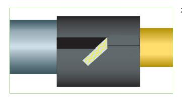
2. Manschette mit 1/3 der Breite auf Schutzrohr platzieren und Verschlußstreifen verkleben
