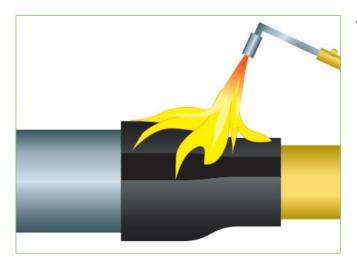
4. Schrumpfung mit weicher Propangasflamme vom Schutzrohr beginnend auf das Mediumrohr
