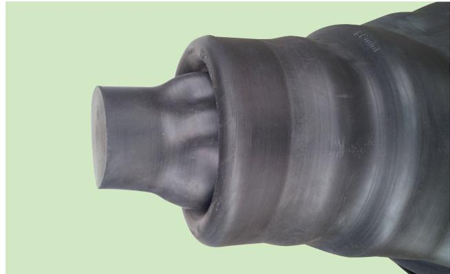
2. Die Manschette über das Medienrohr ziehen, bis sich die Kontur des Rohres deutlich abzeichnet (Dehnbarkeit der Manschette ca. 10%). Dadurch entfaltet sich die AWM Manschette zu einer konischen Form, die die Exzentrizitäten des Medienrohres gut ausgleicht.
