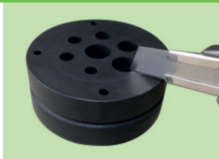
3b. Gummiring bei Bedarf mit einem Messer einschneiden Achtung: Teilungsschnitt auf 12 Uhr Position muss mit Puzzle-Teilung der Druckplatten übereinstimmen.
