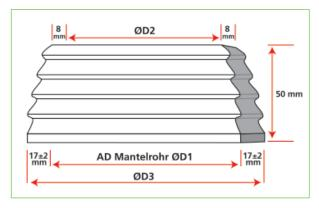
ØD3 montiert = D1 + 34±4 mm
