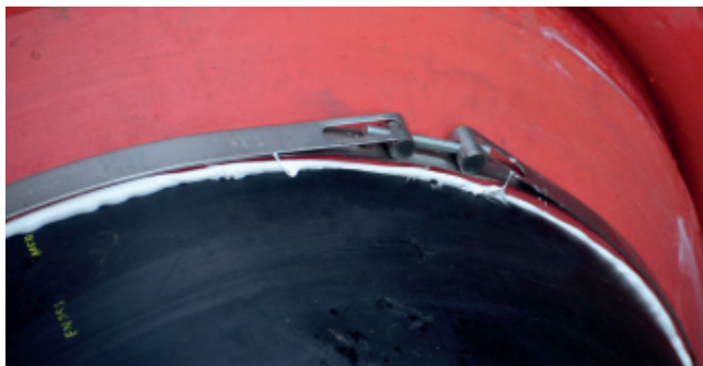
4 pipes Gelenkbolzenband ab DA 315 mm Anzugsdrehmoment 10 Nm
