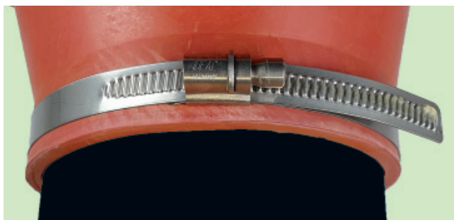
4 pipes Spannband 20 mm breit in V4A für Rohrgrößen DA 75 bis 280 mm , Anzugsdrehmoment 10 Nm
