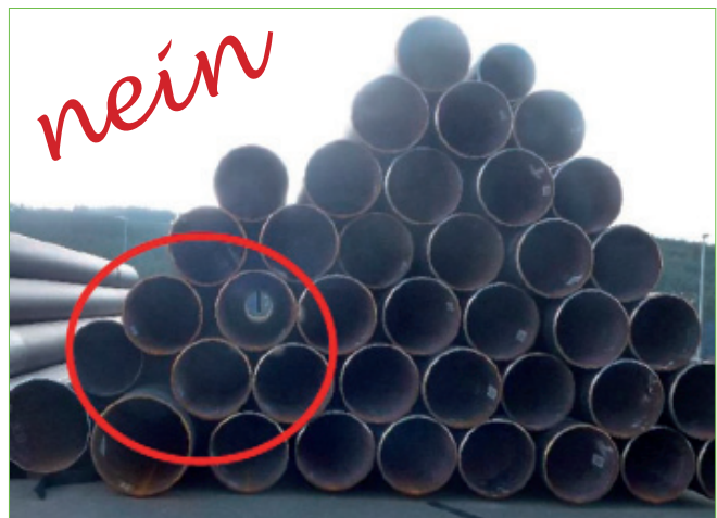
Unterschiedlicher Rohrdurchmesser im selben Stapel
